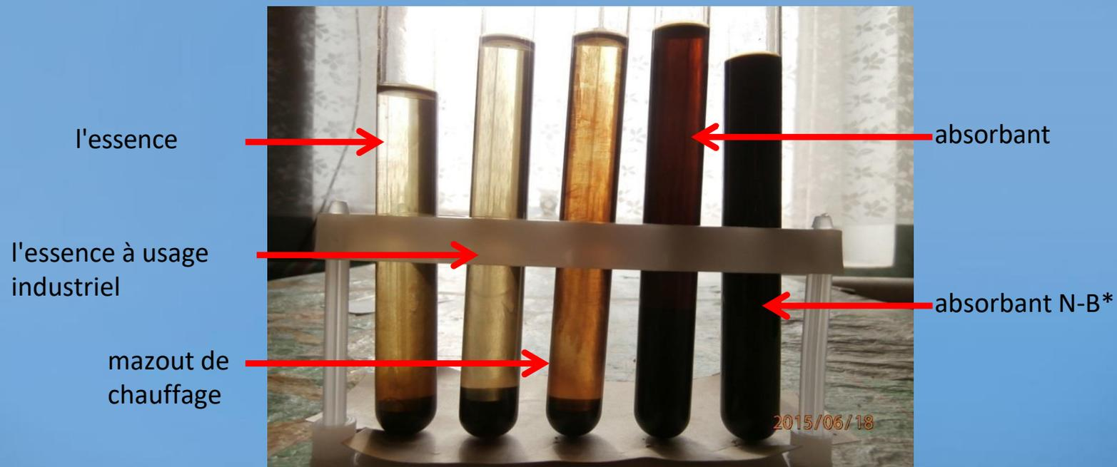
Échantillons de produits pétroliers traités avec un extractant . Dans tous les tubes à essai, on constate qu'un précipité s'est formé. Le produit dans les 3 premiers tubes à essai a pris une couleur claire et l'odeur a diminué.
